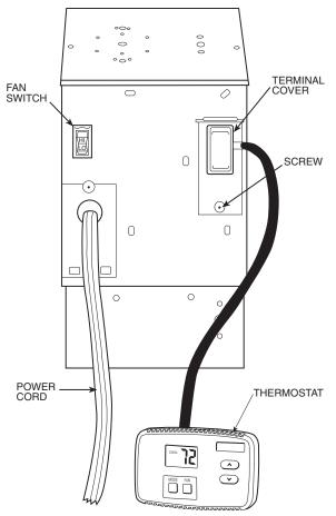
FIGURE 10 — CONTROL BOX TERMINAL COVER
